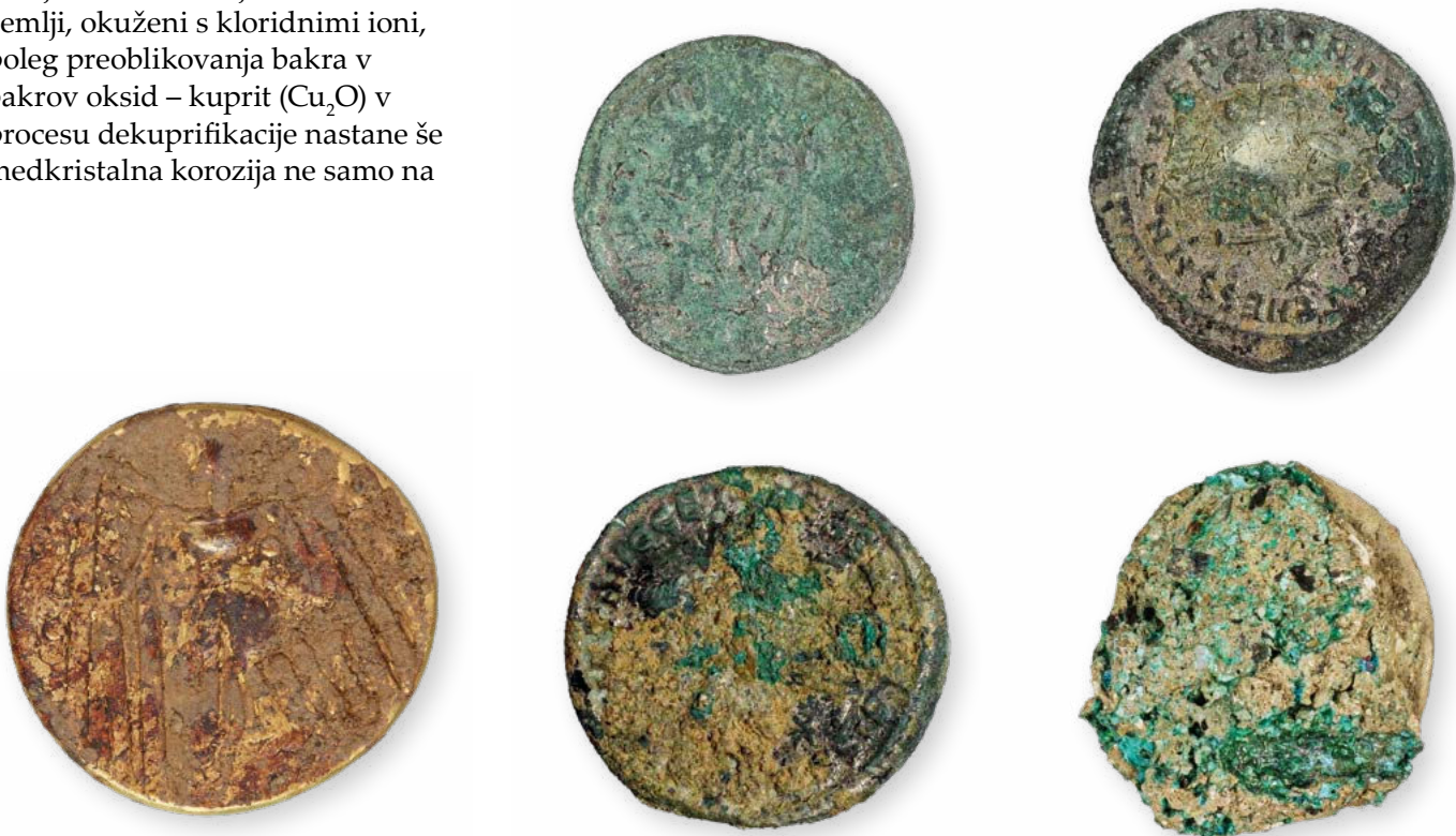
Slika 3: Zlati novci s korozijskimi produkti bakra (Foto: Nataša Nemeček, hrani: Belokranjski muzej Metlika)
