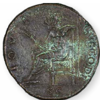
Slika 10: Na konserviranem-restavriranem novcu se je pojavila korozija, ki je posledica kontaminacije z žveplovimi spojinami. (Foto: Nataša Nemeček, hrani: Narodni muzej Slovenije)
