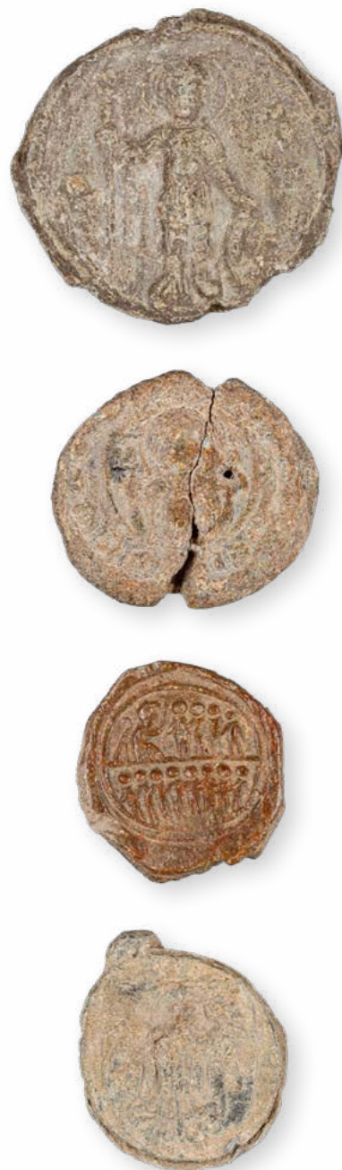
Slika 11: Različni korozijski produkti na svinčenih pečatih (Foto: Nataša Nemeček, hrani: Narodni muzej Slovenije)
