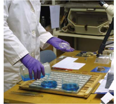
Slika 18: Odstranjevanje bakrovih korozijskih produktov na srebrnikih z raztopino EDTA (Foto: Nataša Nemeček)
