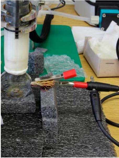
Slika 24: Utrjevalna redukcija z elektrolitskim svinčnikom Pleco (Foto: Nataša Nemeček)
