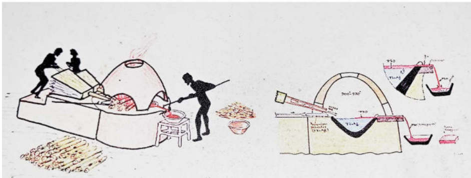
Slika 6: Shematični prikaz izpiranja in praženja rude v kupelacijskih pečeh (Foto: Arheološko najdišče rudnikov srebra v Drymosu, Atika)
