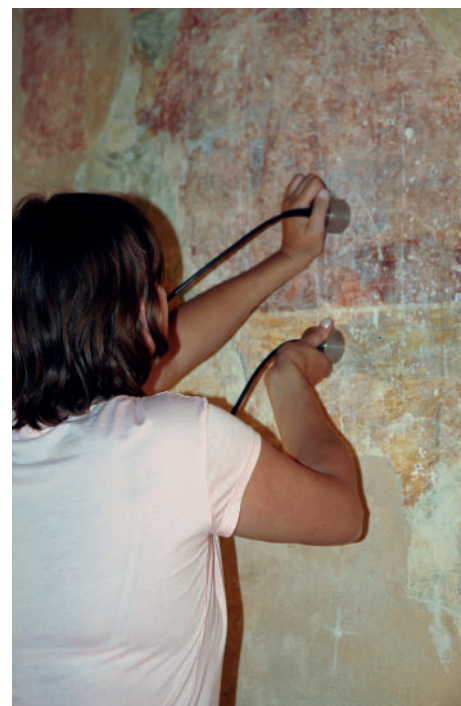
Slika 7: Izvajanje USV-meritev in situ pred nanosom utrjevalca na stenske poslikave
