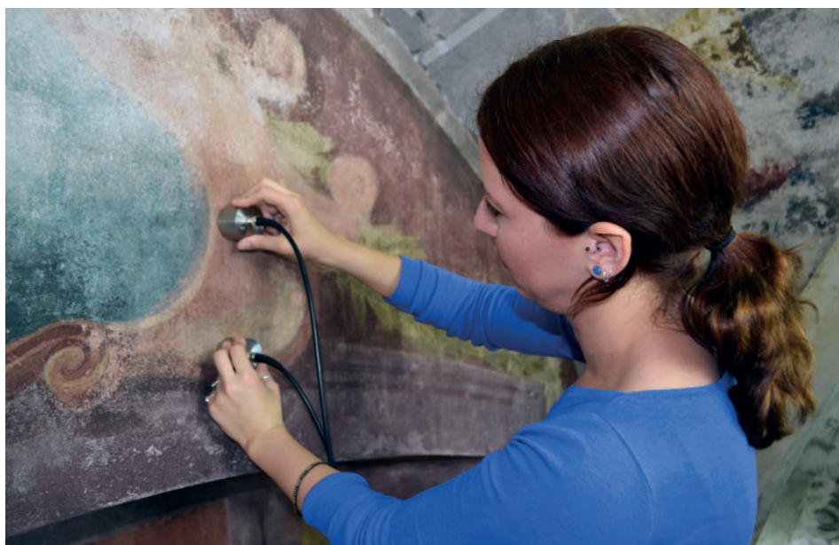
Slika 8: Izvajanje USV-meritev in situ
