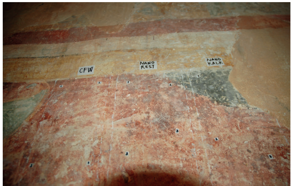
Slika 5: Testno polje z označenimi meritvenimi točkami na stenski poslikavi
