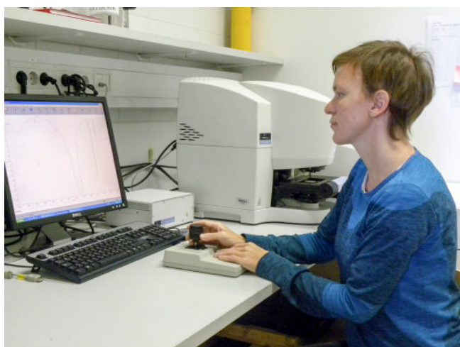
Slika 26: Analiza vzorca z mikrospektroskopom FTIR
