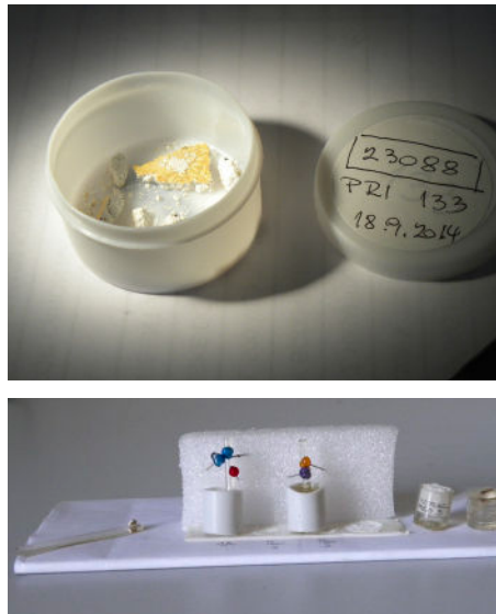
Slika 5: (a) Odvzeti vzorec barvnih plasti, (b) vzorci, zaliti s smolo za pripravo obrusa
