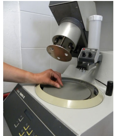
Slika 6: Poliranje površine obrusa
