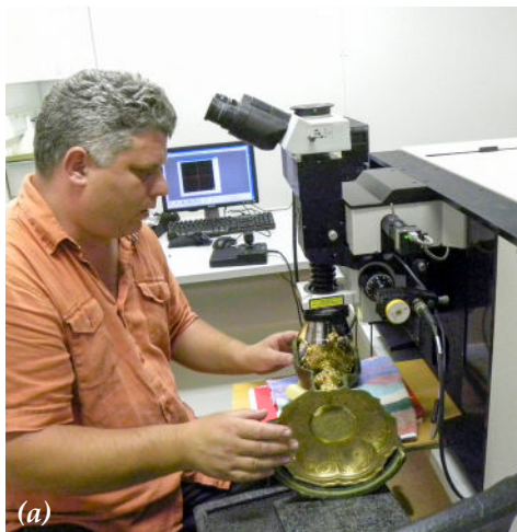
Slika 23: (a) Nameščanje predmeta za preiskavo z ramanskim mikrospektroskopom, (b) izvajanje meritev z ramanskim mikrospektroskopom z rdečim laserskim žarkom
