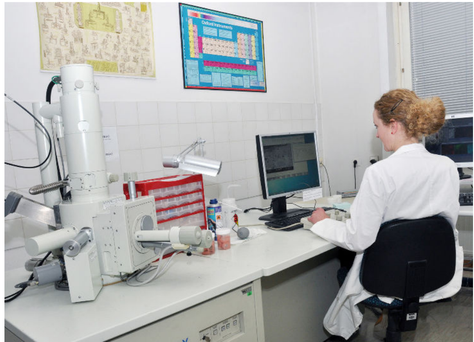
Slika 16: Delo z vrščnim elektronskim mikroskopom z EDS
