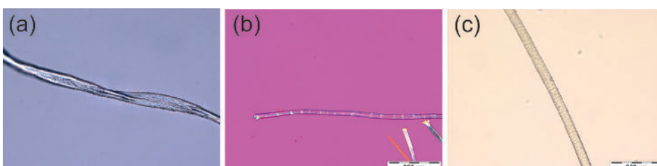
Slika 12: Mikroskopski posnetek različnih naravnih vlaken (z leve: bombaž, lan, volna) v presevni svetlobi
