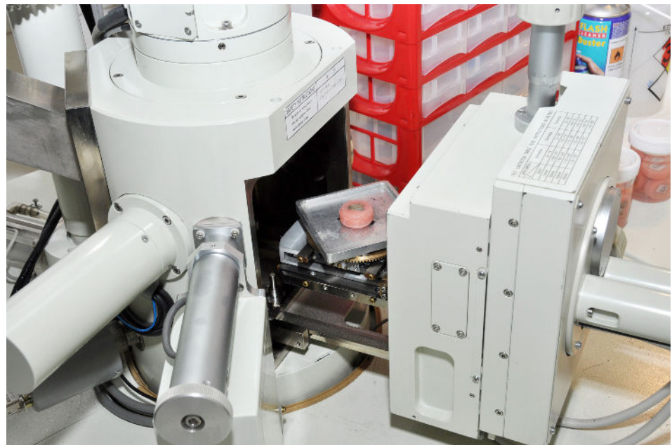
Slika 17: Komora vrščnega elektronskega mikroskopa z brusom vzorca
