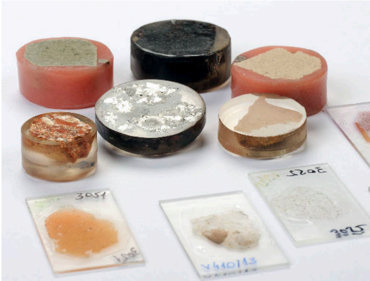
Slika 7: Pripravljeni vzorci obrusov in zbruskov za mikroskopiranje
