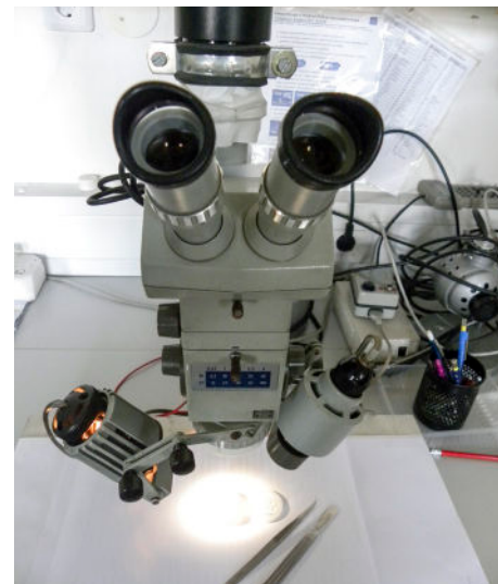
Slika 3: Priprava vzorca za obrus pod stereomikroskopom
