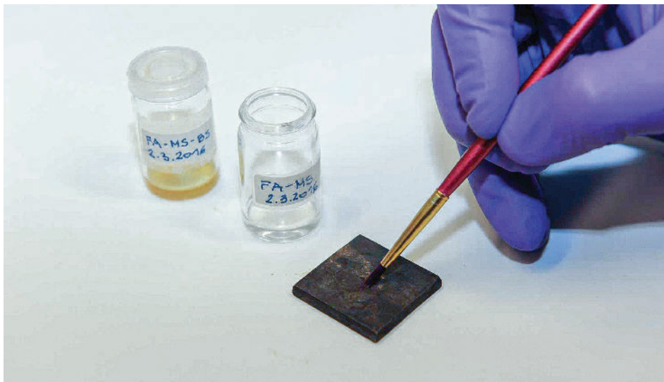
Slika 5: Nanos premaza na osnovi fluoropolimerov na bronasto površino (Foto: Arhiv ZAG, posneto v okviru projekta B-IMPACT)
