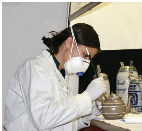
Slika 4: Lakiranje pokrova iz kositrove zlitine s čopičem in raztopino Paraloida B-67 v ksilenu (Foto: arhiv OKR NMS)
