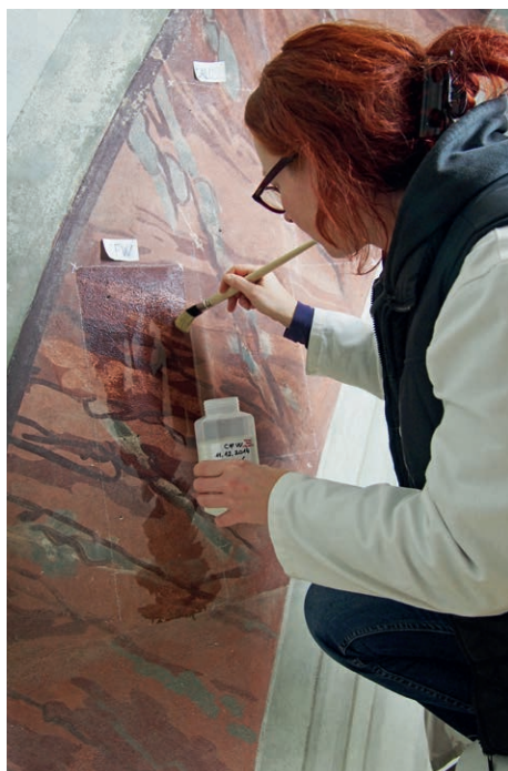
Slika 10: Nanašanje vodne raztopine kalcijevega acetoacetata (CFW) na testno polje stenske poslikave v fresco tehniki
