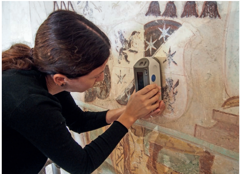
Slika 9: Ugotavljanje barvnih sprememb na stenski poslikavi v secco tehniki s kolorimetrijo
