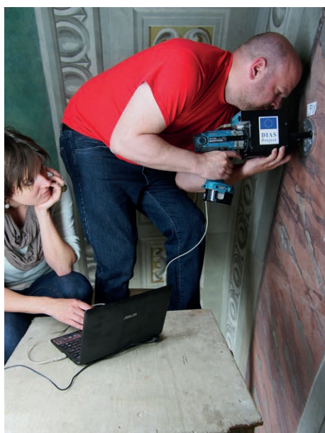
Slika 6: Določevanje učinkovitosti utrjevanja z metodo DRMS (ang. drilling resistance measurement system)
