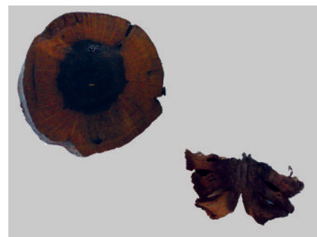
Slika 1: Kos mokrega lesa pred posegom (levo) in po 14 dneh sušenja na zraku (desno)
