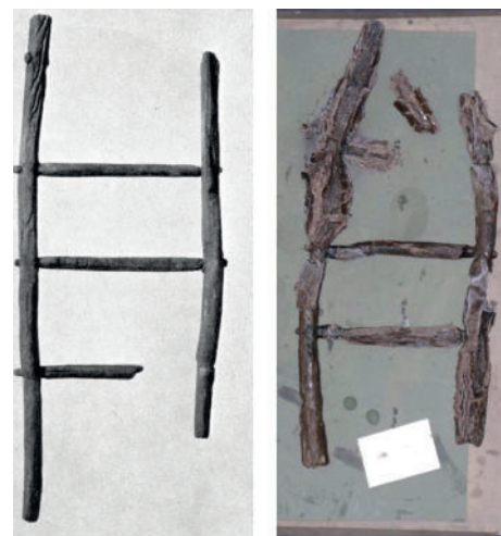
Slika 6: Predmet po konserviranju z galunom (l. 1940) in po 70 letih hrambe
