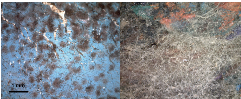
Slika 9: Fotografije, posnete z USB-digitalnim mikroskopom. Vidna je razrast plesni v obliki madežev (levo) in kot puhasta razrast na površini (desno).
