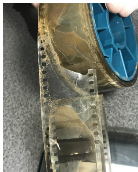
Slika 15: Sledi razkroja nitratnega traku (Foto: Nadja Šičarov)
