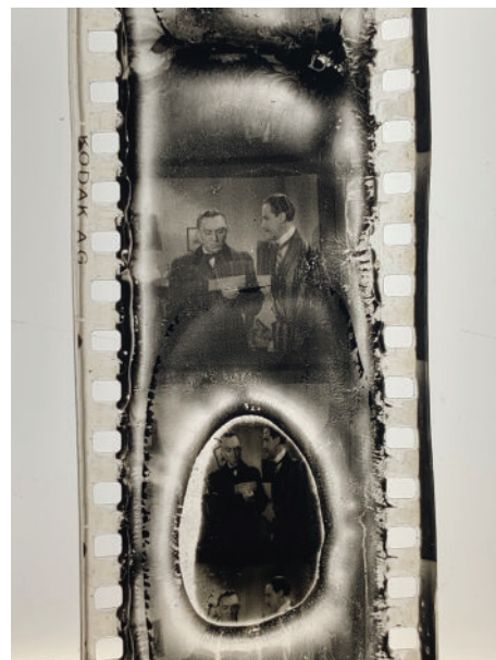
Sliki 10 in 11: Vinegarjev sindrom na acetatnem filmskem traku (Foto: Nadja Šičarov)
