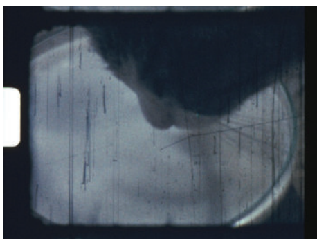
Slika 2: Vertikalne praske na filmskem traku (Do zadnje kaplje, Tatjana Ivančić, 1972, hrani Kinoklub Zagreb)
