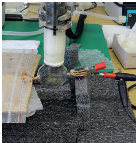
Slika 19: Elektrolitski svinčnik Pleco, ki so ga razvili v Švici. (Foto: Nataša Nemeček)
