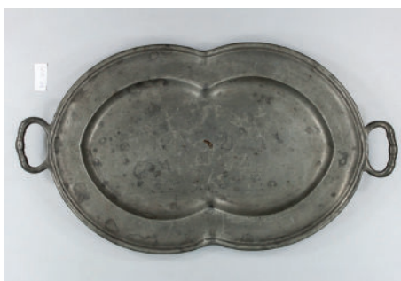
Slika 13: Kositrni pladenj z visoko vsebnostjo svinca (XRF: Sn 69,4 %; Pb 27,7 %; Cu 1,92 %; Sb 0,23 %) iz zbirke Narodnega muzeja Slovenije pred posegi, primer interkristalne korozije na meji med svincom in kositrom (Foto: Nataša Nemeček, hrani Narodni muzej Slovenije)
