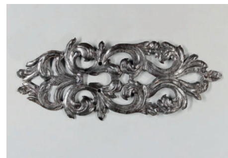
Slika 15: Železno okovje, površinsko obdelano po t. i. postopku »terne« (XRF: Pb 53,8 %; Sn 46,2 %) (Foto: Nataša Nemeček, hrani Narodni muzej Slovenije)
