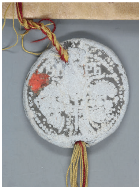
Slika 23: Beli prašnati korozijski produkti na srednjeveškem pečatu iz 13. stoletja iz zbirke Arhiva Republike Slovenije kot posledica izpostavljenosti hlapom organskih kislin (Foto: Nataša Nemeček)
