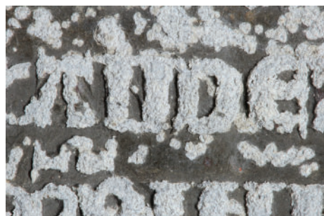
Slika 11: Primer predmeta z aktivno korozijo zaradi prisotnosti hlapov organskih kislin (Foto: Nataša Nemeček, hrani Arhiv Republike Slovenije)
