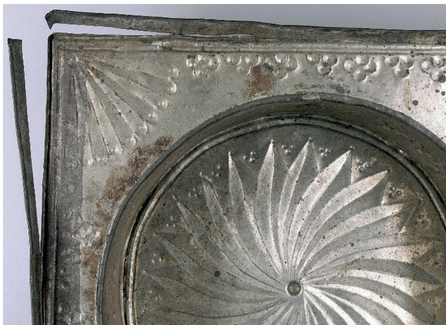
Sliki 23 in 24: Poškodovana pokositrena škatla za shranjevanje pečatov ter lepljenje poškodovanih delov škatle s steklenimi vlakni in Aralditom 2020 (hrani Arhiv Republike Slovenije)
