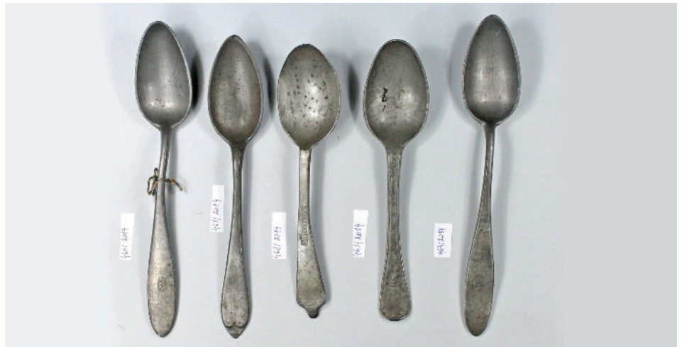
Slika 4: Črne pike kositrovega oksida na žlici, konservatorska številka 462/2014, sestava zlitine (XRF): Sn 94,3 %, Pb 1,87 %, Cu 2,37 %, As 1,21 % (hrani Narodni muzej Slovenije)
