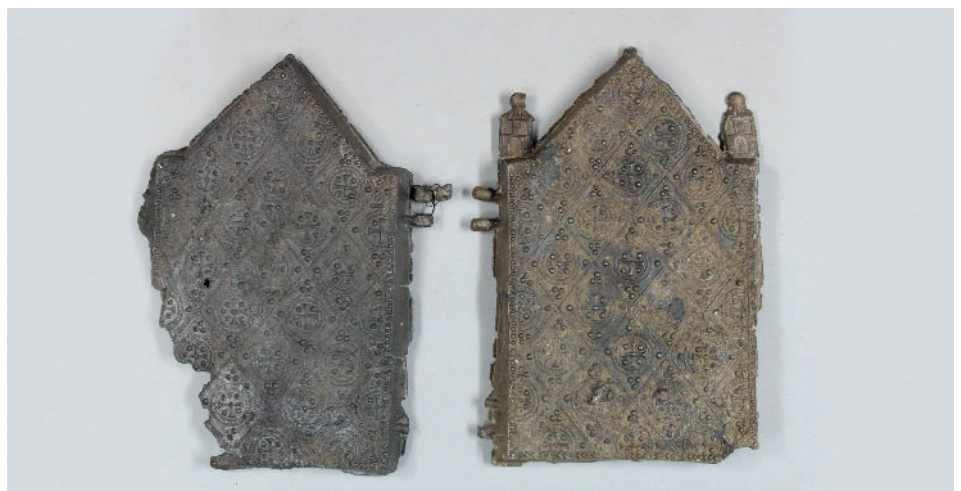
Slika 7: Rumenorjava korozija (kositrov(IV) sulfid?) na hrbtni strani dvokrilnega oltarčka, sestava zlitine (XRF): Sn 74,4 %, Pb 24,5 %, Cu 0,61 %, Bi 0,2 % (hrani Narodni muzej Slovenije)
