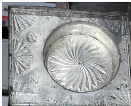
Sliki 21 in 22: Pokositrena škatla za pečate pred odstranjevanjem korozijskih produktov s 5-odstotno raztopino EDTA in potem (hrani Arhiv Republike Slovenije)
