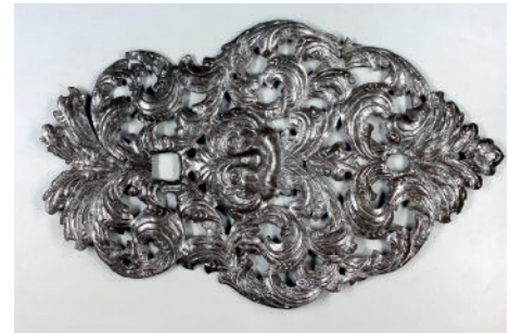
Sliki 18 in 19: Okov iz pokositrene železne pločevine s porumenelim lakom in galvansko korozijo ter okov po odstranitvi propadlega laka in galvanske korozije s peskanjem, konservatorska številka 586/2015 (hrani Narodni muzej Slovenije)
