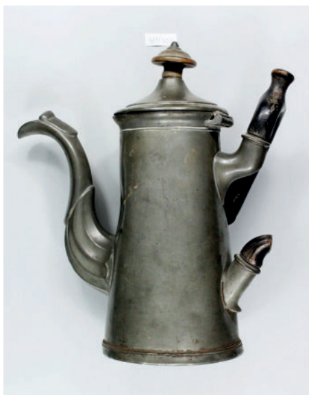
Slika 8: Ročka za kavo iz zlitine britanija z vidnimi korozijskimi produkti in mehanskimi poškodbami, sestava zlitine (XRF): Sn 89 %, Sb 7,13 %, Pb 1,94 %, Cu 1,80 %, Bi 0,13 % (hrani Narodni muzej Slovenije)
