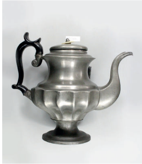
Slika 16: Ročka za kavo iz zlitine britanija po zaključenih posegih, sestava zlitine (XRF): Sn 90 %, Sb 7 %, Pb 1,97 % in Cu 0,6 % (hrani Narodni muzej Slovenije)
