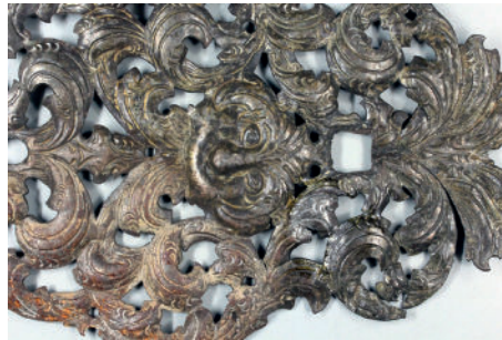
Sliki 18 in 19: Okov iz pokositrene železne pločevine s porumenelim lakom in galvansko korozijo ter okov po odstranitvi propadlega laka in galvanske korozije s peskanjem, konservatorska številka 586/2015 (hrani Narodni muzej Slovenije)
