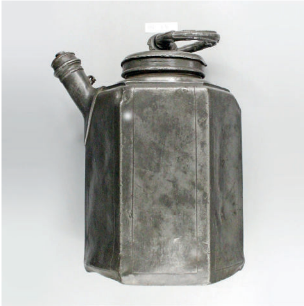
Slika 11: Neenakomerno obarvana površina kositrnega predmeta z veliko svınca, sestava zlitine (XRF): Sn 65,6 %, Pb 30,7 %, As 2,49 %, Cu 0,9 % (hrani Narodni muzej Slovenije)
