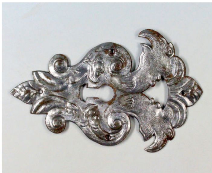
Slika 9: Primer ščitka iz pokositrenega železa s primerom galvanske korozije, sestava zlitine (XRF): Sn 48,2 %, Pb 47,7 %, Cu 2,31 %, As 1,12 %, Bi 0,4 %, Sb 0,2 % (hrani Narodni muzej Slovenije)
