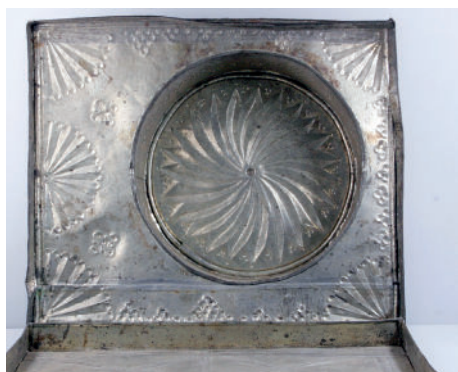
Sliki 21 in 22: Pokositrena škatla za pečate pred odstranjevanjem korozijskih produktov s 5-odstotno raztopino EDTA in potem (hrani Arhiv Republike Slovenije)
