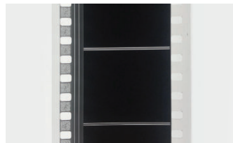
Slika 22: Digitalna zvočna sled Dolby Digital med perforacijami (ob levi strani filmske sličice) (Foto: Nadja Šičarov)
