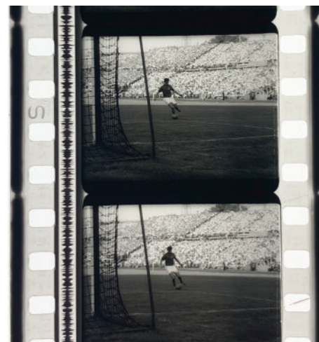
Slika 5: Acetatni filmski trak, ki ga prepoznamo po obrobni kodi »S«. (Foto: Nadja Šičarov)
