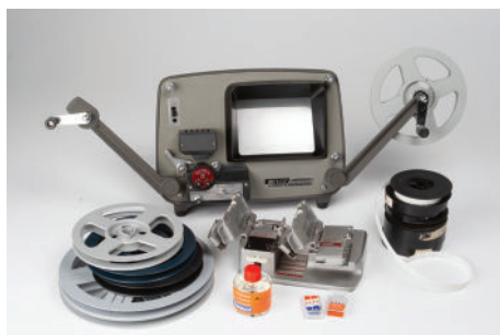
Slika 13: Oprema za montažo super 8-milimetrskega filma: montažna miza, koluti, lepilnica, lepilo (Foto: Martin Podrzavnik, hrani Slovenska kinoteka)
