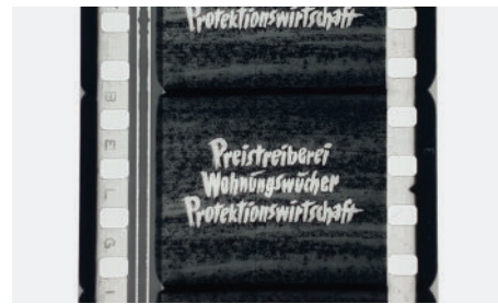
Slika 20: Optična zvočna sled v obliki visokokontrastne valovite linije (ob levi strani filmske sličice) (Foto: Nadja Šičarov)
