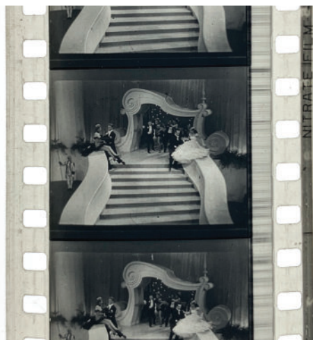
Slika 4: Nitratni filmski trak, ki ga prepoznamo po obrobni kodi »nitrate film«. (Foto: Nadja Šičarov)
