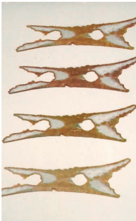
Slika 15f: Brezbarvno in poizkusno barvno 3D tiskanje piščali (Foto: Andrej Žužek)
