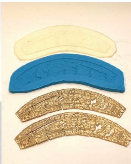
Slike 14h, i, j: Galvanoplastična izdelava večjega in manjšega našivka (Foto: Miran Pflaum)
