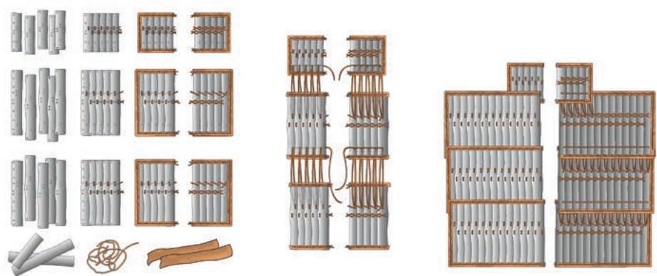
Slika 17e: Shematski prikaz sestavljanja in šivanja lamel (Risba: Miran Pflaum)
