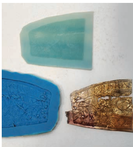
Slika 14e: Preizkusni 3D natis in testna galvanoplastična kopija dela večjega našivka (Foto: Miran Pflaum)
