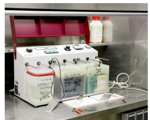
Slika 20: Enota za elektrolitsko razmaščevanje, srebrenje in zlatenje manjših predmetov v trilitrskih kopelih.
