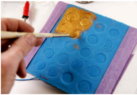
Slika 22: Bronco v prahu s čopičem pazljivo vtremo v površino kalupa.
