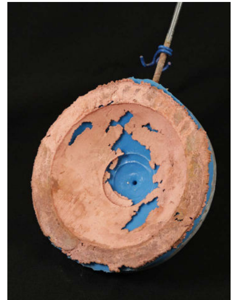
Slika 35: Videz notranjega dela kopije, pri kateri se na delu kalupa nanašanje bakra ni vzpostavilo.
