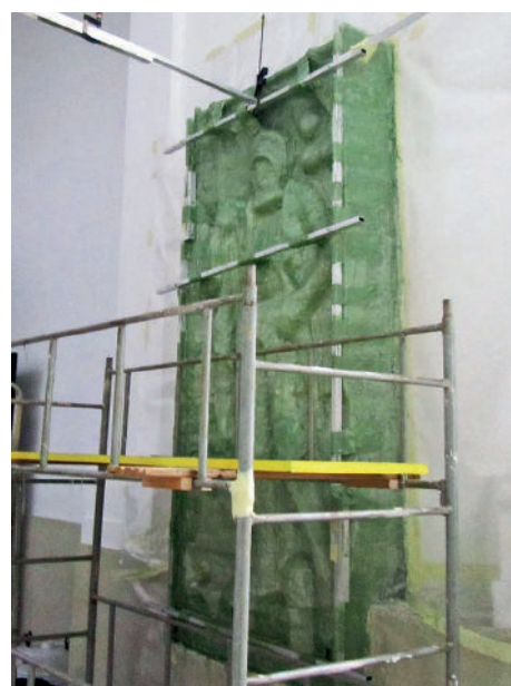
Slika 6f: Izdelava kalupa: izdelava kape iz obarvane poliestrske smole z dodatkom kalcitne moke in ok. 160 g steklene tkanine. Za dodatno ojačanje in trdnost ter odpornost proti zvižanju so bile v kapo vdelane 2 x 3 cm velike aluminijaste profilne palice. Vogalna robova zgoraj sta bila zaradi lažje odstranitve kape izdelana tako, da so zgornji in oba stranska dela povezani z vijaki in razmakljivi.
