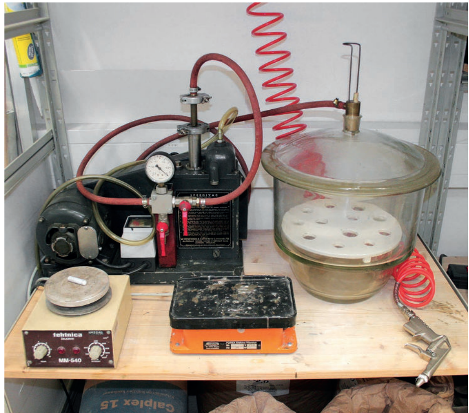
Slika 10: Nekaj pripomočkov za odlivanje kopij: magnetno mešalo, vibrirna mizica in pištola za stisnjeni zrak ter vakuumska črpalka s steklenim zvonom v ozadju
