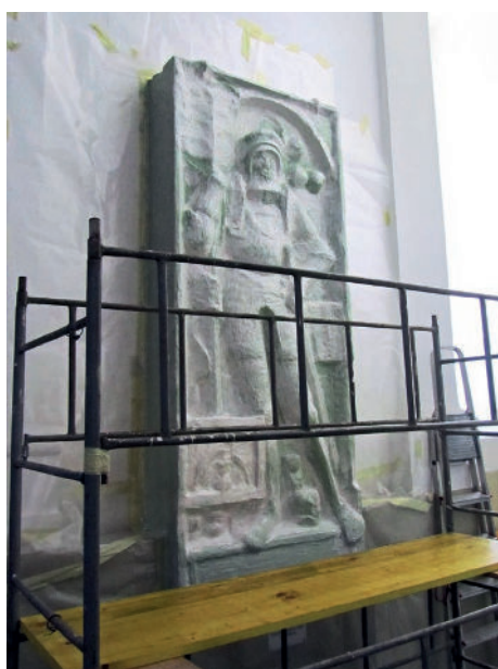
Slika 6e: Izdelava kalupa: nanos tretje plasti silikonskega kavčuka, s katero so se zagladili morebitni nezapolnjeni deli armature in odpravili negativni koti pred izdelavo kape. Za odpravo večjih negativnih kotov so bili med drugo in tretjo plast gume lokalno vstavljeni deli mehke poliuretanske pene.
