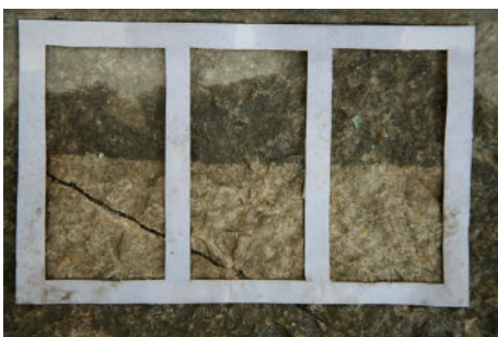
Slika 8: Razlika med z laserji očiščenimi in neočiščenimi površinami (sondiranje). Med okenci so različne nastavitve – parametri, zgoraj in spodaj pa je prikazana razlika med očiščeno in neočiščeno površino.
