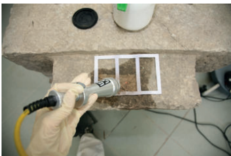
Slika 7: Čiščenje kamnitega nagrobnika z laserjem.
