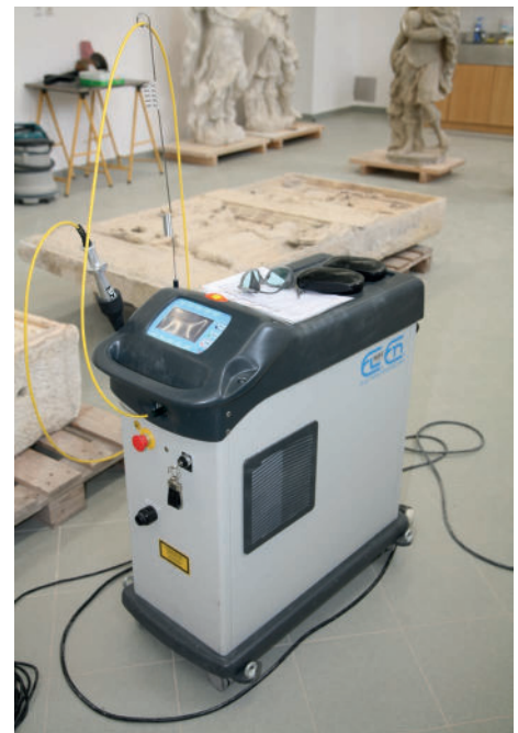
Slika 4: Komercialni laserski sistem za čiščenje (Nd:YAG) z Oddelka za kamen in štukaturo Restavratorskega centra ZVKDS. Model laserja: Smart Clean 2.
