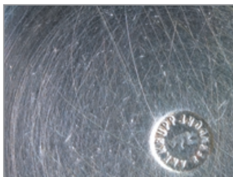
Slika 12: Predmet – srebro: praske na površini zaradi čiščenja
