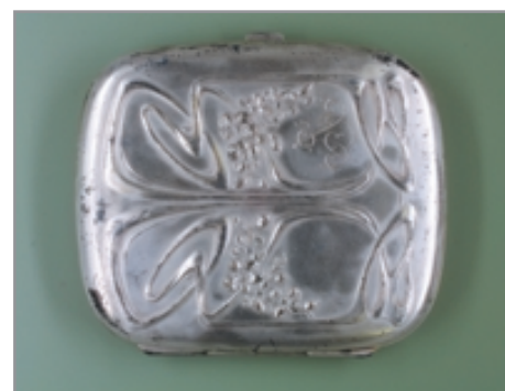
Slika 11: Cigaretnica – srebro: odstopanje obogatene srebrne površine
