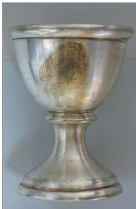
Slika 16: Skledica za jajce – srebro: prstni odtis na očiščeni površini
